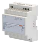
GW 90 802 مصدر كهرياء 24 فلف تيار مستمر - 2.5 أمبير 100 240- فلف تيار متردد - 60/50 هرتز
